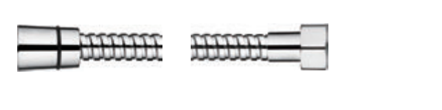
MM44 150-190см Хром Внутренняя труба из PVC Латунная гайка Латунный конус Латунная торцевая втулка Растягивающийся от 150 до 190см
