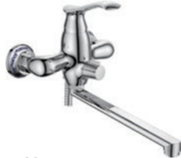
LM2341 Излив: L30F Смеситель для ванны с длинным изливом 300мм. Дивертор в корпусе
