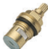
LM52-2 Кран-букса 1/2" для смесителя (15 шлицов) Угол поворота 90°
