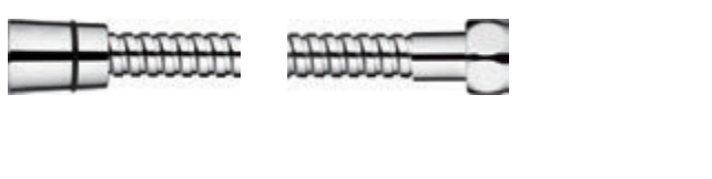
LM46 150см Внутренняя труба из EPDM + нейлоновая оплётка Латунная гайка Латунный конус Латунная торцевая втулка Защита от разрыва
