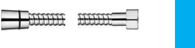
MM42 150см Хром Внутренняя труба из EPDM + нейлоновая оплётка Латунная гайка Латунный конус Латунная торцевая втулка Защита от разрыва
